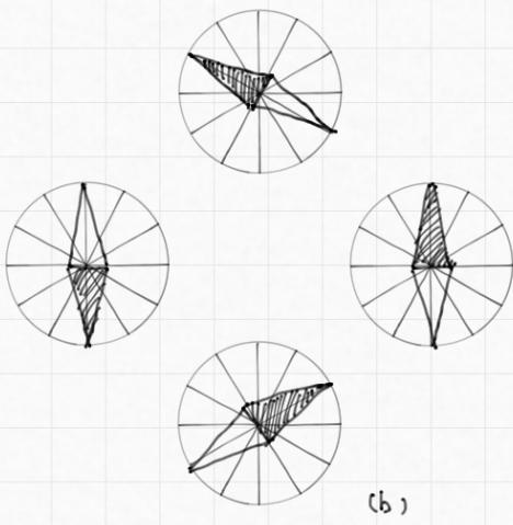
左の図のように、地磁気は常に北向きにかかり。電流の作用磁場は右ねじの法則に従って、反時計まわりとなる。
