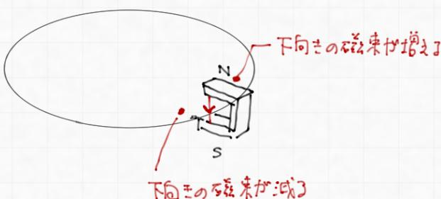
キ 磁石が近づくことにより下向きの磁束が増加するので、上向きの磁場を作るように起電力が生じる。したがって 左回り (2) のうす電流が流れず
