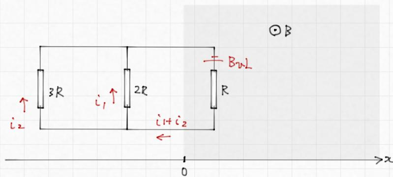
1. 上向きの磁束が増加している  $B_vL$  ( $a \rightarrow b$  に電流を流す向き)
