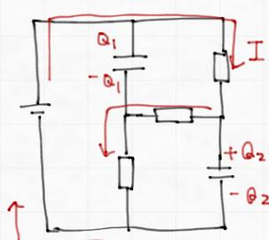
S<sub>2</sub>, S<sub>3</sub> を閉じてから S<sub>1</sub> を閉じたとき、閉じた直後  $Q_1 = Q_2 = 0$   $V_{ab} \doteq E$
