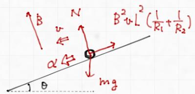
右辺に速度  $v$  に比例して逆向きに働く力があるで十分な時間が経った後、速度は一定に (加速度は 0 となる) なる。このときの速さを  $v_f$  だから
