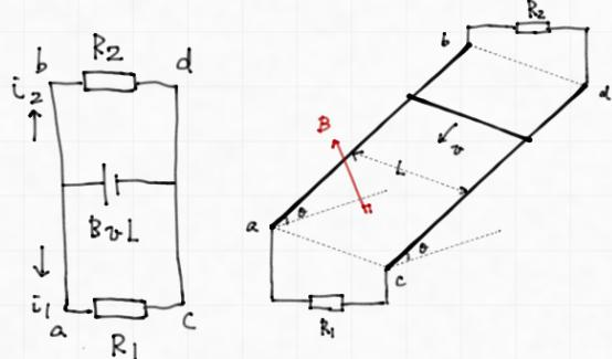
抵抗1を流れ電流は大きさ  $\frac{BvL}{R_1}$  向きは  $a \rightarrow c$
