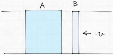
(8) 流体塊 B の厚みを  $d$  とすると  $S d = V_0$  より  $d = \frac{V_0}{S}$
