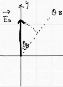
(1) (a) 偏光板Aを通過した光の振幅ベクトルを  $\vec{E}$ 。とするとその向きは  $y$  の向きで。このとき光検出器では  $I_0(A)$  の電流が流れ、偏光板Bを通過することで振幅ベクトルは  $|E_0| \cos \theta_B$  の大きさとなるので、光検出器で検出される電流は  $\cos^2 \theta_B \times I_0$ 。
